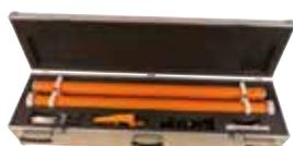
**CMD – Mini Explorer** sonda a tre profondità 0.5 / 0.25 m, 4.2 / 2.1 m, 1.0 / 0.5 m, 1.8 / 0.9 m per archeologia, agricoltura e ingegneria civile, permettendo una valutazione immediata sul gradiente di conducibilità verticale.
