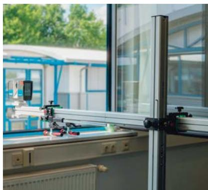
Sistema per il posizionamento laterale a sbalzo del laser scanner per scansioni di facciate, tetti e aree esterne da finestre e abbaini.
