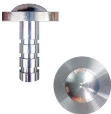
Caposaldo di livellazione per materializzare stabilmente un punto di quota nota sia orizzontale che verticale.
