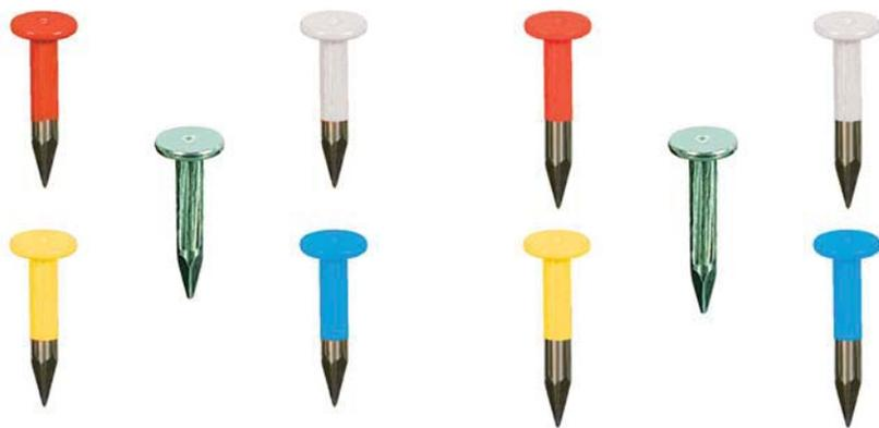
Chiodino topografico in acciaio HR (alta resistenza) temperato elettro-zincato, con nervature. Gambo diametro 4mm Lunghezza **25mm** Testa diametro 10mm svasata al centro
