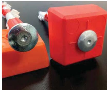
Testa con svasatura per la materializzazione del punto a terra
