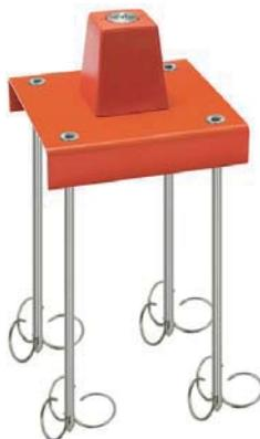
Cippo poligonale costituito da: una **testa poliroc**, un piastrino "alluminio" e una piastra di supporto quadrata. Il cippo poligonale FENO (fornito già assemblato) è pronto all'uso. Solo i quattro chiodi d'ancoraggio devono essere posizionati dal Tecnico Agrimensore.
