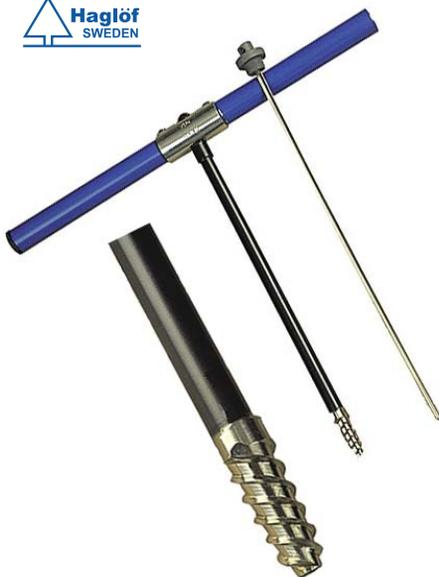
Il Succhiello di Pressler, detto anche Sonda Incrementale o Trapano Carotatore, viene utilizzato per prelevare campioni nei tronchi al fine di valutare età, crescita, salute dell'albero, influssi negativi da inquinamento, densità del legno.
