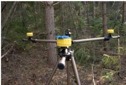
Lo strumento Postex® viene utilizzato per calcolare la posizione di alberi o di oggetti, principalmente in aree di saggio. Postex® è un ottimo strumento per seguire l'evoluzione dei singoli alberi in lunghi progetti di studio in aree di saggio permanenti.
