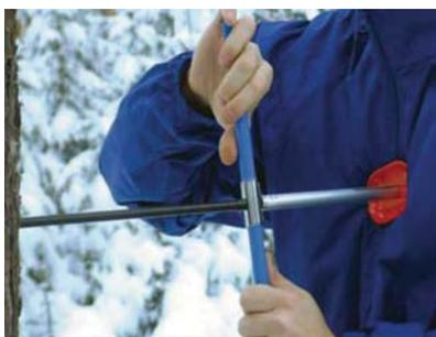
Strumento pieghevole utile per facilitare l'inserimento del succhiello di Pressler nella corteccia anche in presenza di lastre di ghiaccio.
