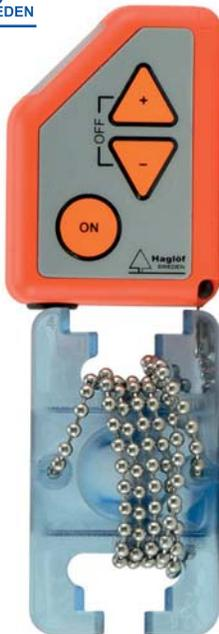
L'EC II D-R è un clinometro elettronico con indicatore di fattore. Utilizzate EC II D-R per le letture di altezza e le stime dell'area di base.
