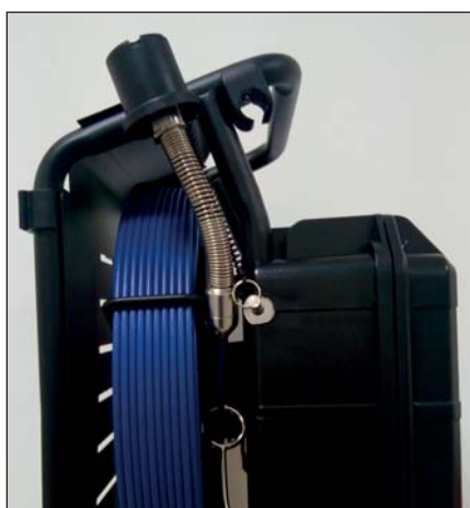
Maniglia di trasporto e protezione metallica antiurto
