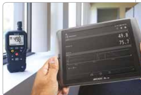
MR77 mentre trasmette i dati a un tablet Android con FLIR Tools Mobile.
